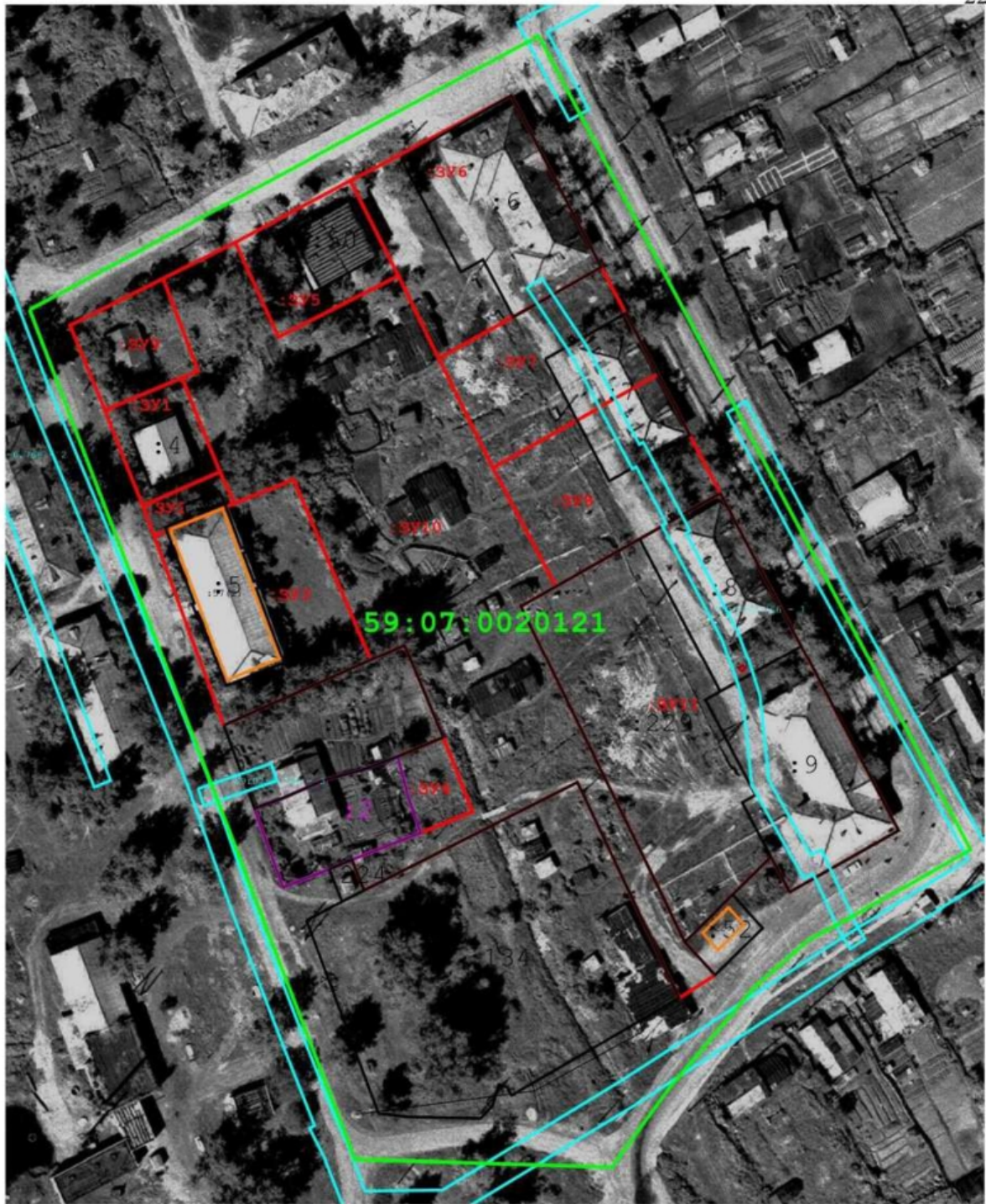
Рис. 9 Общий чертеж с нанесением образуемых и уточняемых земельных участков, ЗОУИТ, участков имеющих в ЕГРН на ЦОФП
