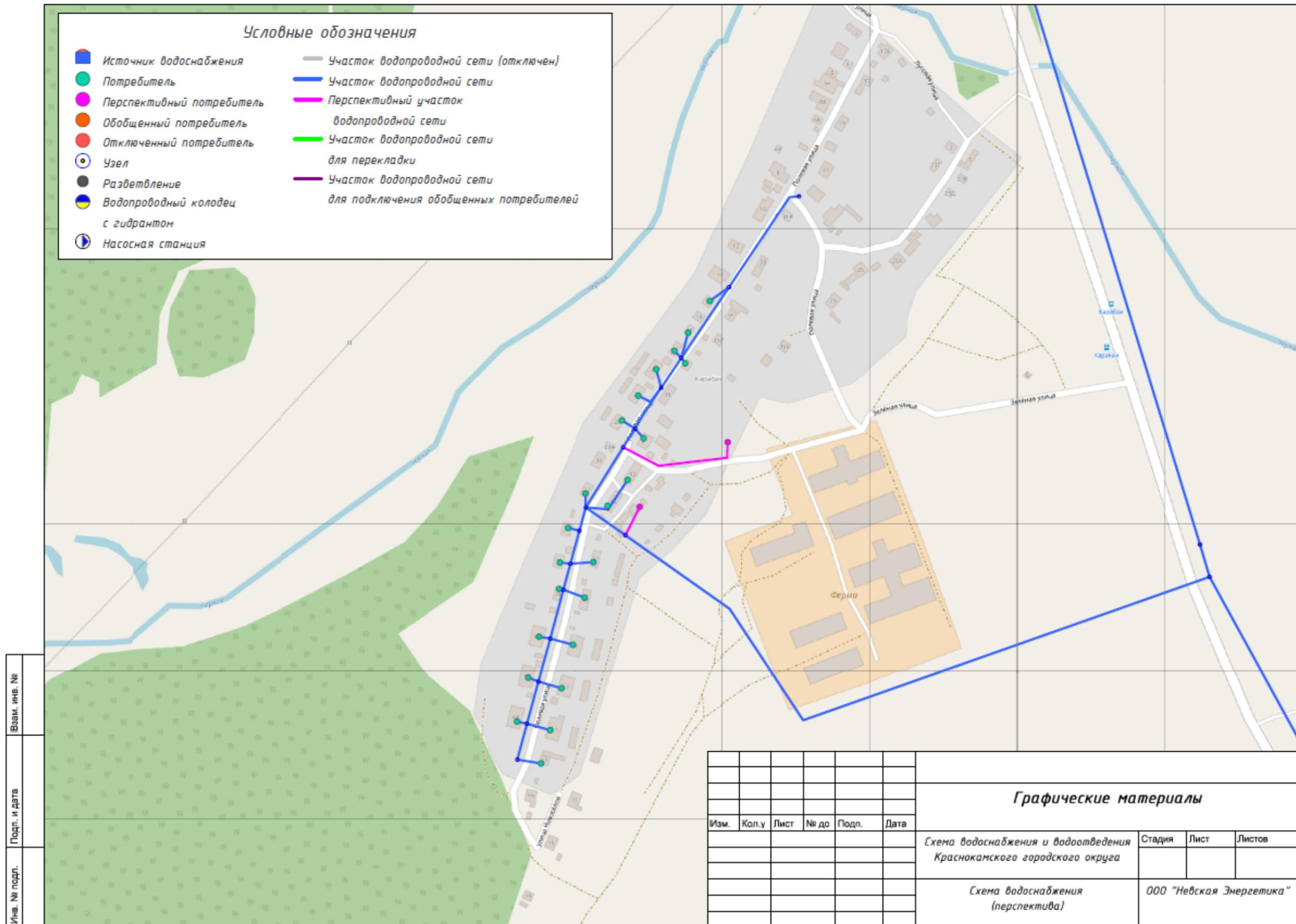
Рисунок 13 - Графические материалы существующего положения в сфере водоснабжения д. Карабаи на период до 2041 года
