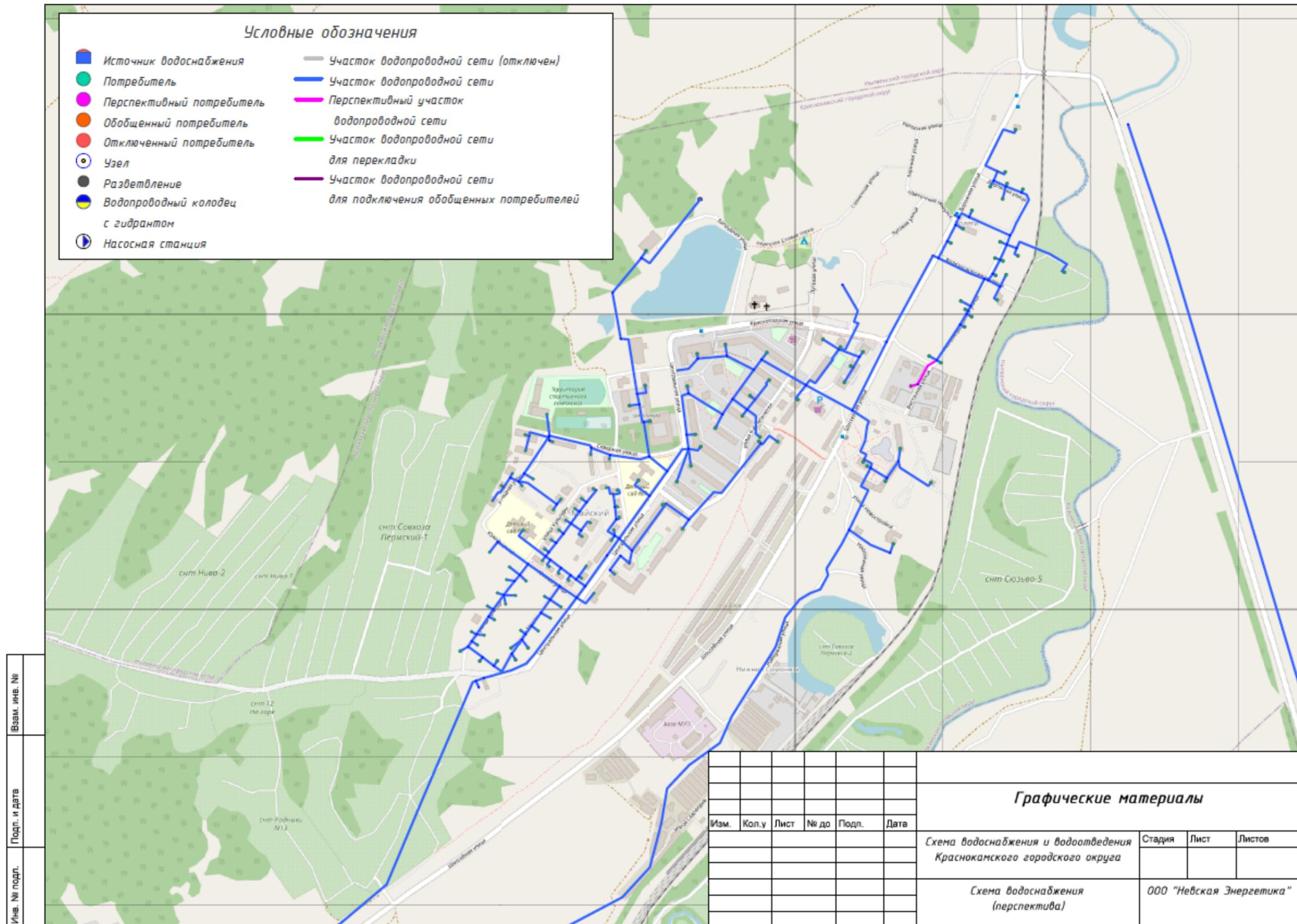
Рисунок 11 - Графические материалы существующего положения в сфере водоснабжения п. Майский, д. Волеги на период до 2041 года
