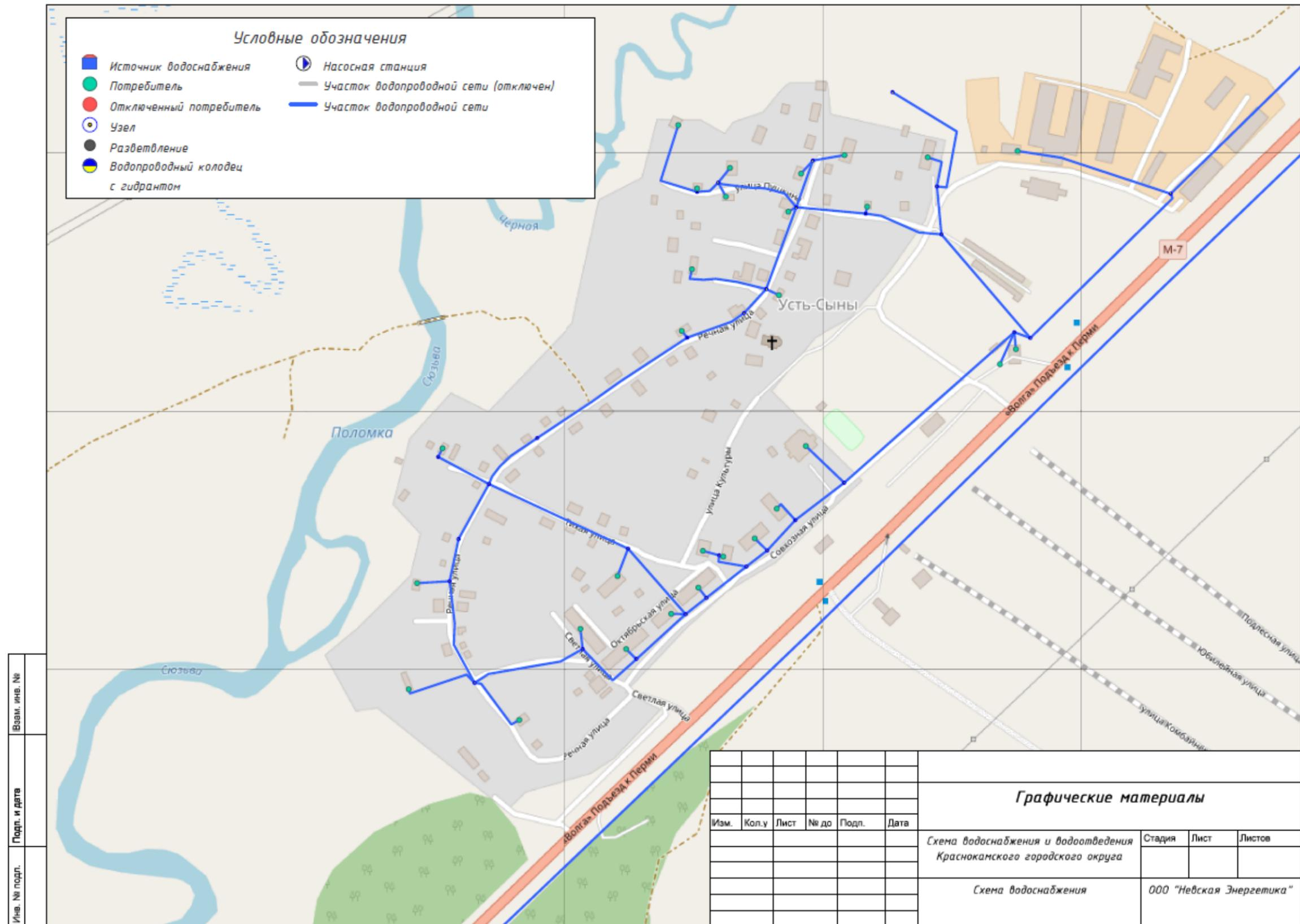
Рисунок 3 - Графические материалы существующего положения в сфере водоснабжения с. Усть-Сыны
