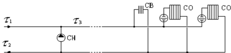
Рисунок 56 - Схема ЦТП (ИТП) с насосом смешения на перемычке
