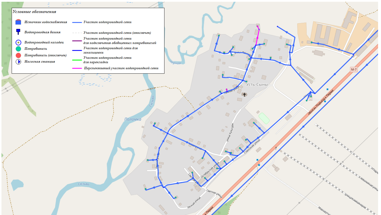
Рисунок 67 - Расположение существующих и проектируемых трубопроводов и расположение существующих и проектируемых сооружений централизованной системы водоснабжения с. Усть-Сыны
