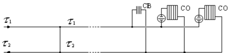
Рисунок 28 - Схема ЦТП (ИТП) с непосредственным присоединением
