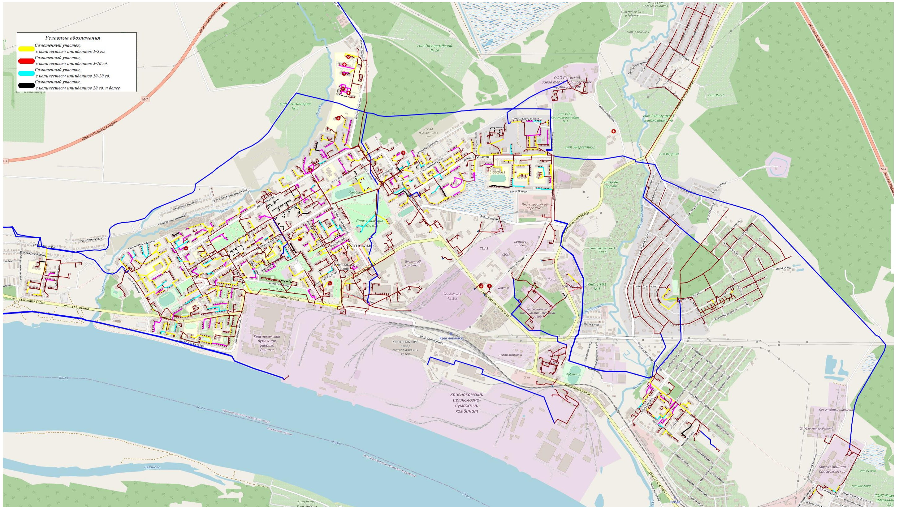
Рисунок 99 - Схема ненормативной надежности сетей водоотведения г. Краснокамска с графическим изображением количества инцидентов на канализационных сетях за 2022 г.
