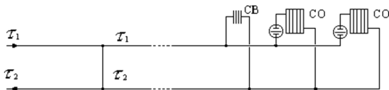
Рисунок 28 - Схема ЦТП (ИТП) с непосредственным присоединением
