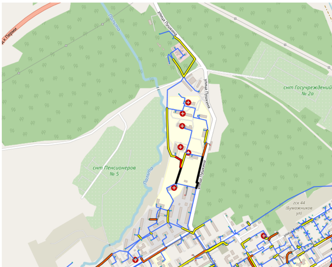
Рисунок 61 - Участки водопроводной сети по ул. Пушкина, г. Краснокамск, Ду 150-200 мм, общей протяженностью 290,5 м
