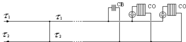
Рисунок 57 - Схема ЦТП (ИТП) с непосредственным присоединением
